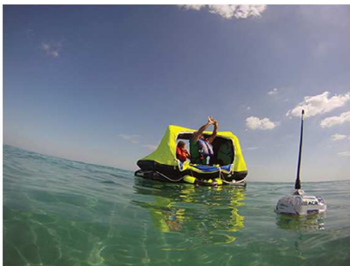
Εικόνα 6.9: Το Epirb ρίχνεται στη θάλασσα – Συγκρατείται στο liferaft με το σχοινί που το συνοδεύει (Photo: www.bwsailing.com)
