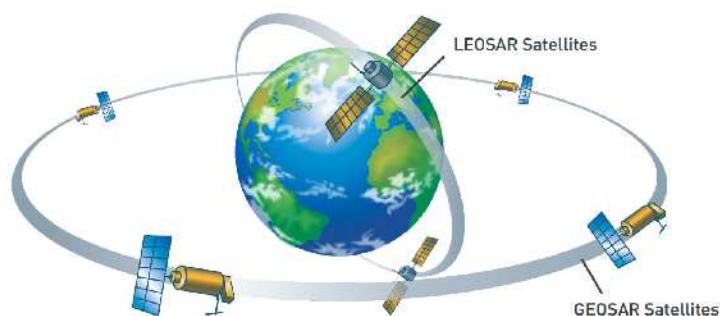
Εικόνα 6.2: Δορυφόροι χαμηλής και γεωστατικής τροχιάς COSPAS SARSAT (Photo: www.oceansignal.com )
