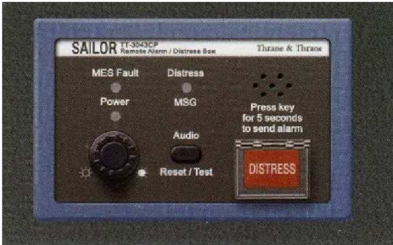
Εικόνα 5.28: Πλήκτρο ενεργοποίησης συναγερμού πάνω στο Inmarsat-C. (Photos: www.shipwonders.com)
