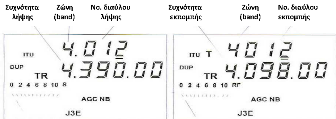
Εικόνα 4.5: Επιλογή τηλεφωνικού διαύλου 4012 και μορφή επικοινωνίας τηλεφωνία (J3E) με το πλήκτρο MODE
