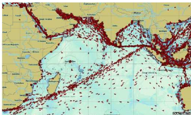
Εικόνα 4.44: Ανίχνευση πλοίων μέσω δορυφορικού AIS στον Ινδικό Ωκεανό (Photo: www.bbc.co.uk)
