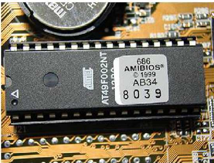
Εικόνα 1.5: ΜΝΗΜΗ ROM (με εγκατεστημένο το λειτουργικό BIOS) (Photo: www.hardwaresecrets.com )
