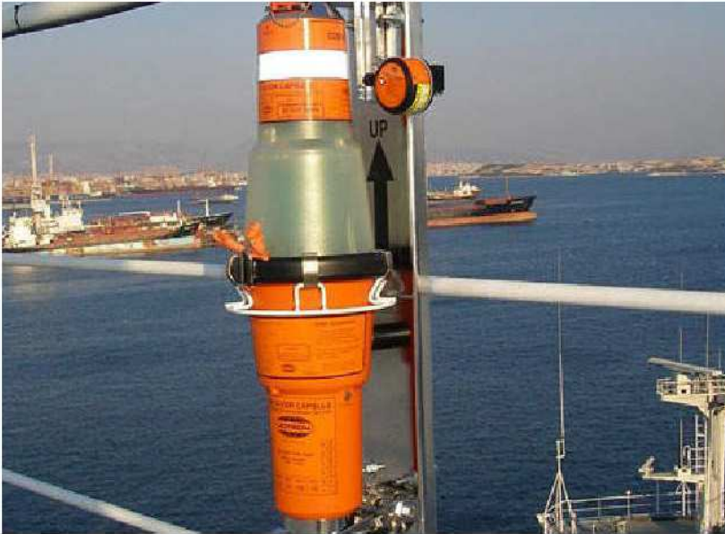
Εικόνα 6.22: Ραδιοφάρος COSPAS SARSAT με ενσωματωμένο GPS και καταγραφέα S-VDR (Photo: www.marcomm.ru )
