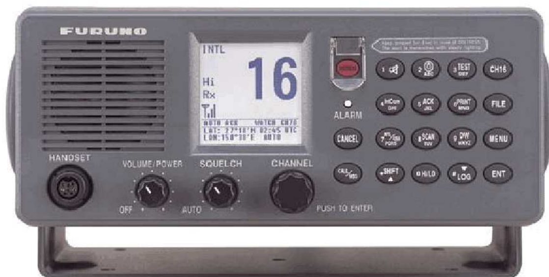
Εικόνα 4.1: Π/Δ VHF/DSC (Photo: www.transoceansurveyors.com )
